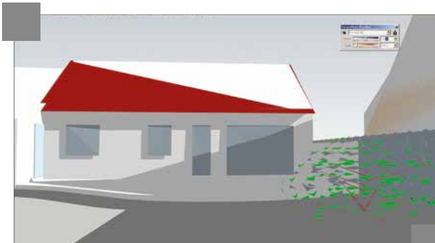
Vue de face permettant d'estimer la proportion de la surface de baie vitrée ombrée.
